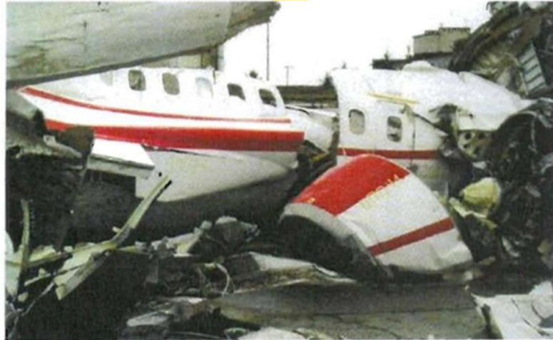
01 фрагменты 00024 и 00027 фюзеляжа, вид со стороны левого борта
